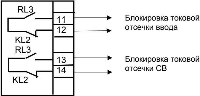
Рис. 6.5. Пример выполнения схемы ЛЗШ-УРОВ
