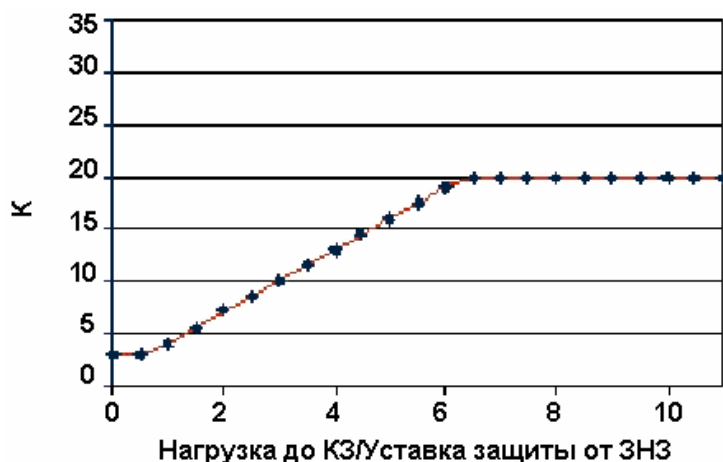
Рис. 7.38. автоматическая подстройка коэффициента K
