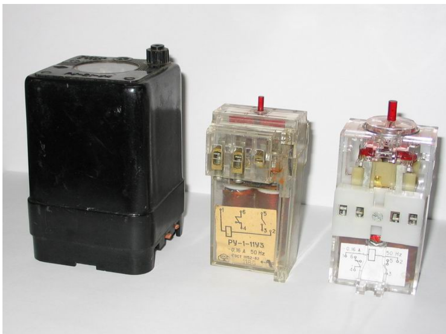
Рис. 18.1 Указательные реле. Слева направо: РУ-21, РУ-1, РЭУ-11.
