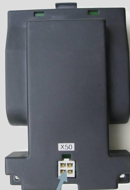
Подключение преобразователя напряжения к разъему X50
