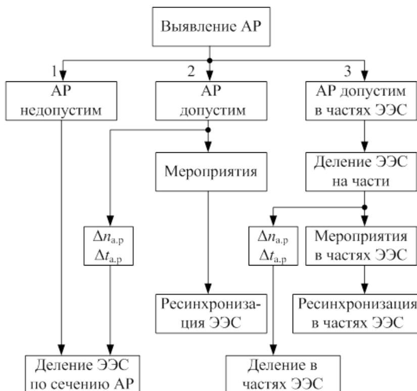
Рис. 3.6. Алгоритм ликвидации асинхронного режима
