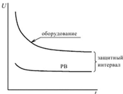
Рис. 4.4 Вольт-секундные характеристики изоляции защищаемого оборудования и вентильного разрядника
