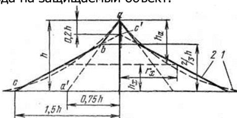
Рис. 4.2 Зона защиты стержневого молниеотвода (1) и ее упрощенное построение (2).
