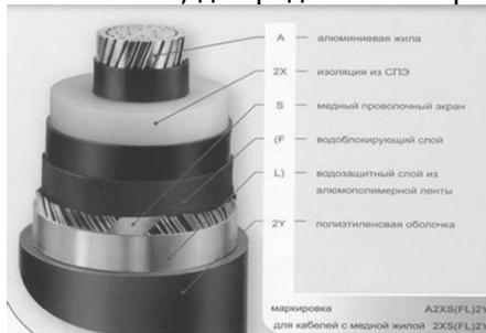
Рис. 2.9 Элементы конструкции СПЭ-кабелей с пластмассовой оболочкой
