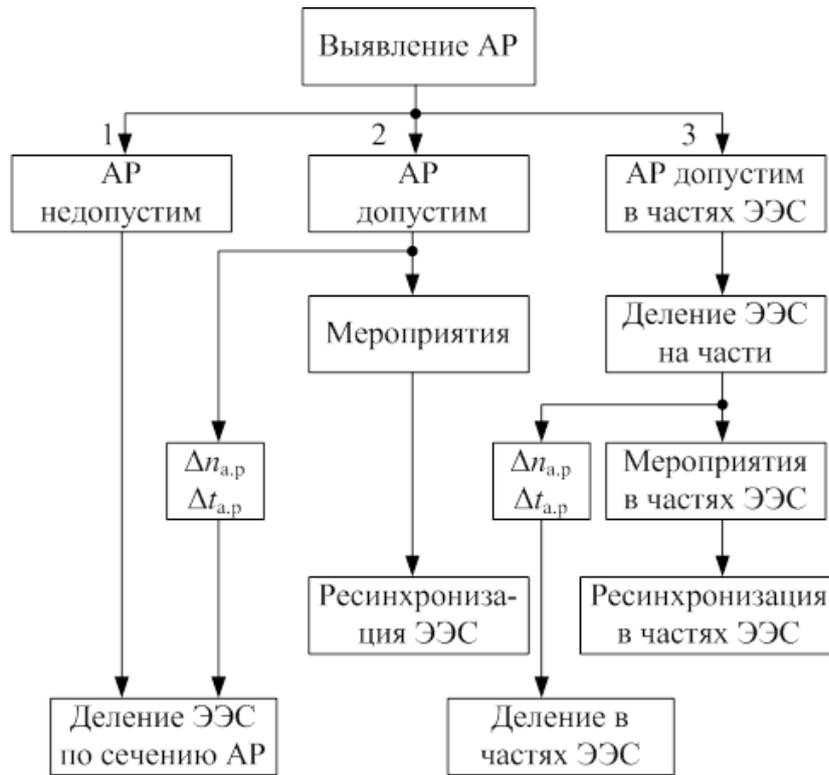
Рис. 3.1. Алгоритм ликвидации асинхронного режима
