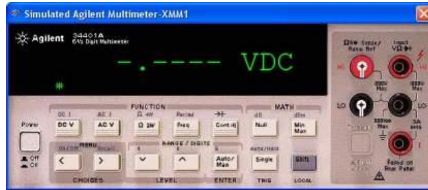
Рис. 1.5. Лицевая панель эмулированного мультиметра Agilent XMM1
