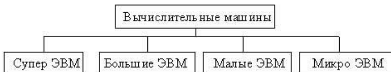
Рис. 5. Классификация ЭВМ по размерам и вычислительной мощности
