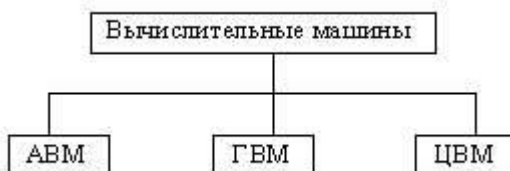
Рис.2. Классификация вычислительных машин по принципу действия.
