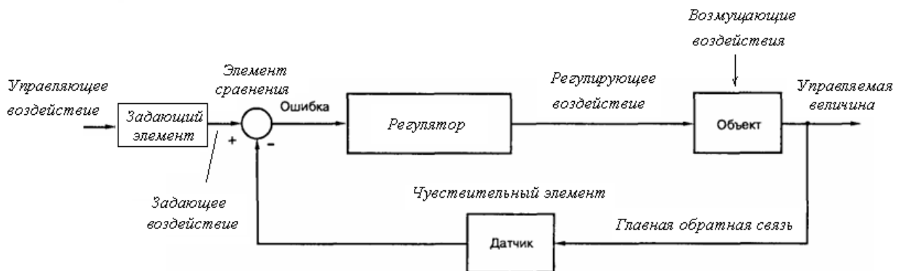
Рис. 1. Обобщенная функциональная схема системы управления
