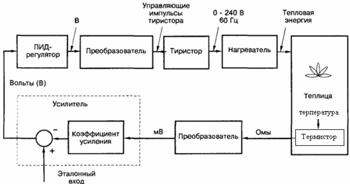
Рис. 3. Функциональная схема системы регулирования температуры в теплице
