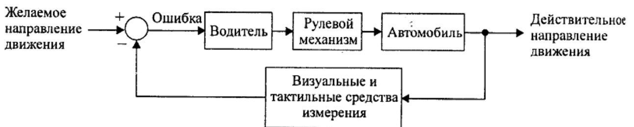
Рис. 1. Функциональная схема системы управления движением автомобиля
