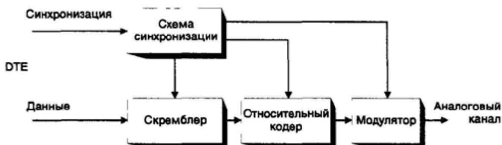
Рис. 5. Схема передатчика синхронного модема
