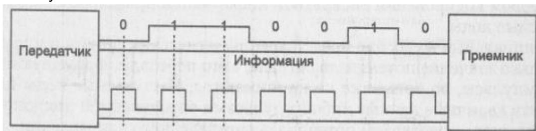
Рис. 1. Синхронизация приемника и передатчика на небольших расстояниях
