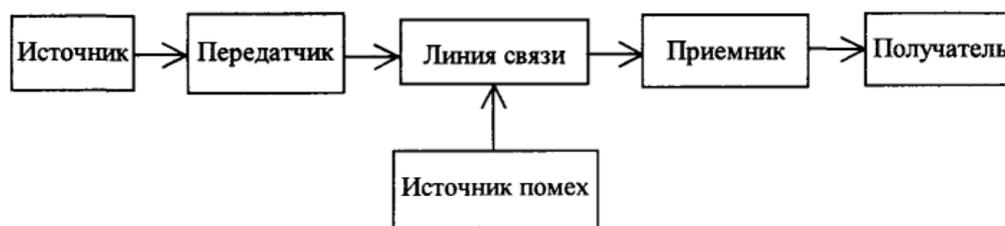
Рис. 2. Обобщенная схема системы передачи информации
