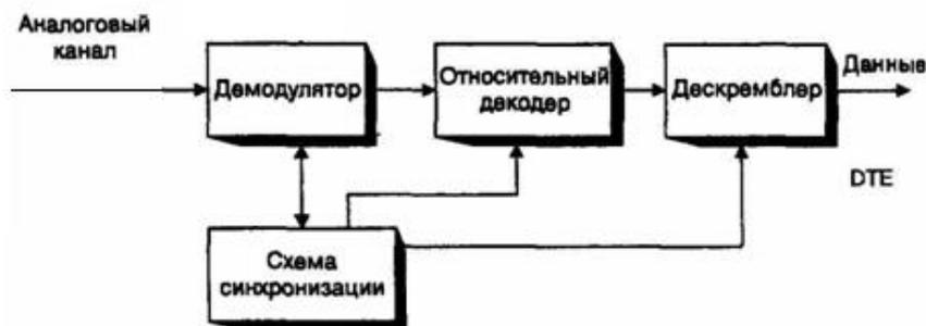
Рис. 6. Схема приемника синхронного модема
