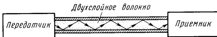
Рис. 6. Принцип распространения оптического излучения
