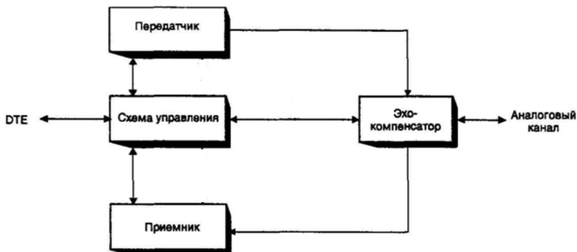
Рис. 4. Схема синхронного модема
