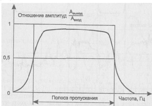
Рис. 1. Амплитудно-частотная характеристика
