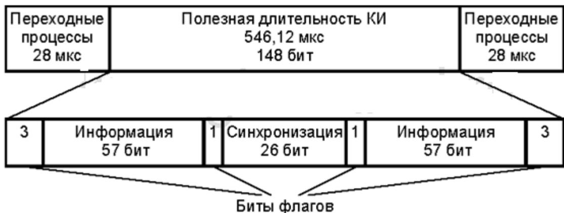
Рис. 6. Структура КИ GSM
