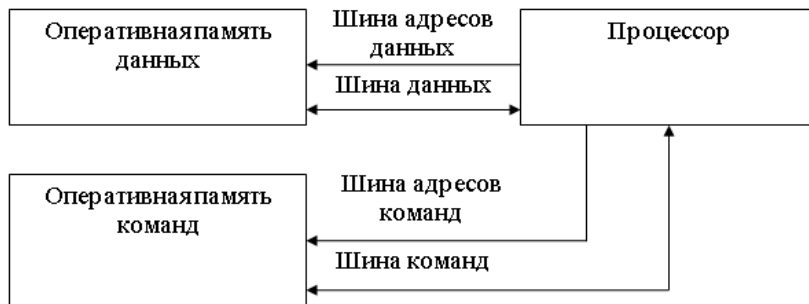
Рис. 16. Гарвардская архитектура с разделяемой памятью
