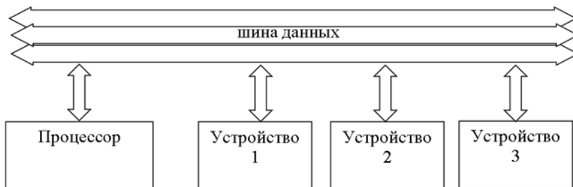
Рис. 18. Схема информационного обмена с использованием шины
