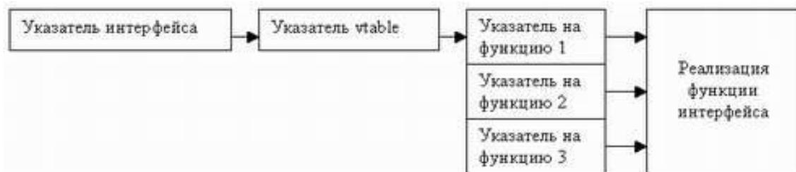
**Рис. 2.3.** Схема работы указателя СОМ-интерфейса
