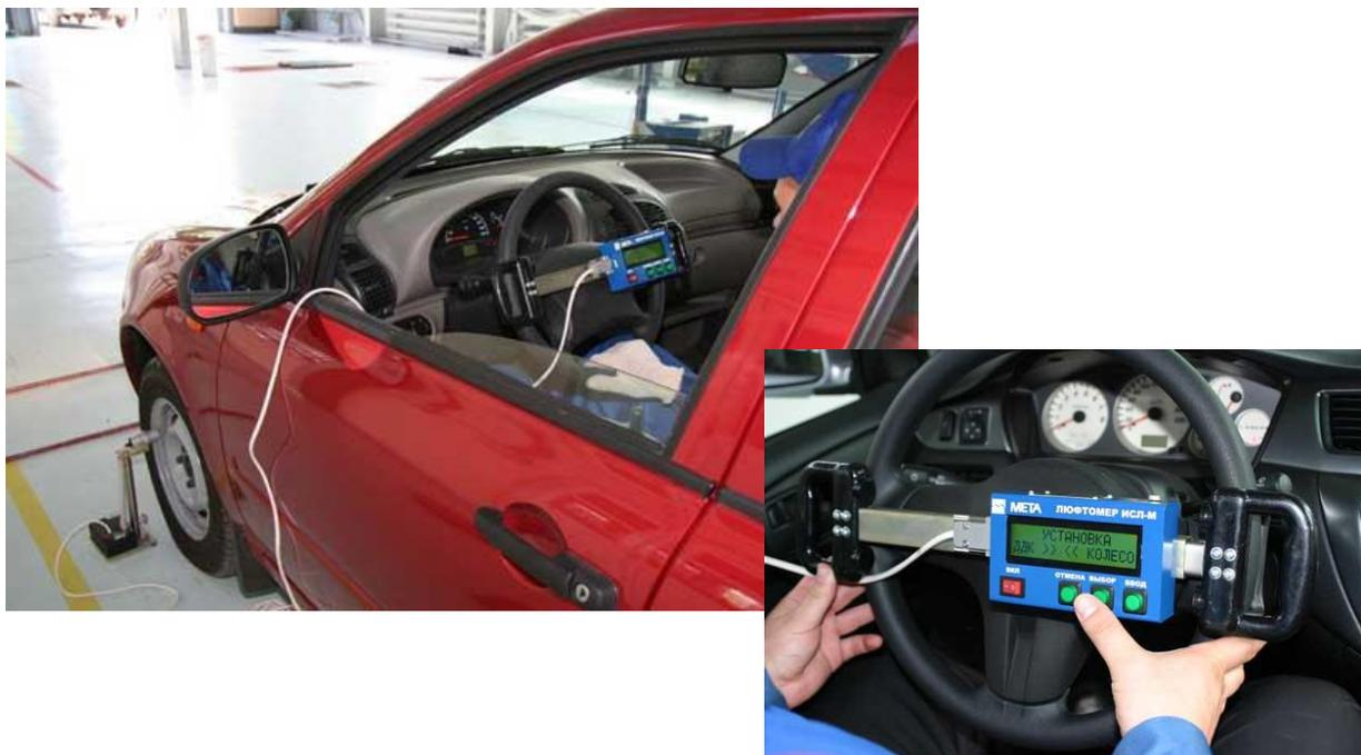
Рисунок 8.13 - Измеритель суммарного люфта рулевого управления ИСЛ-М
