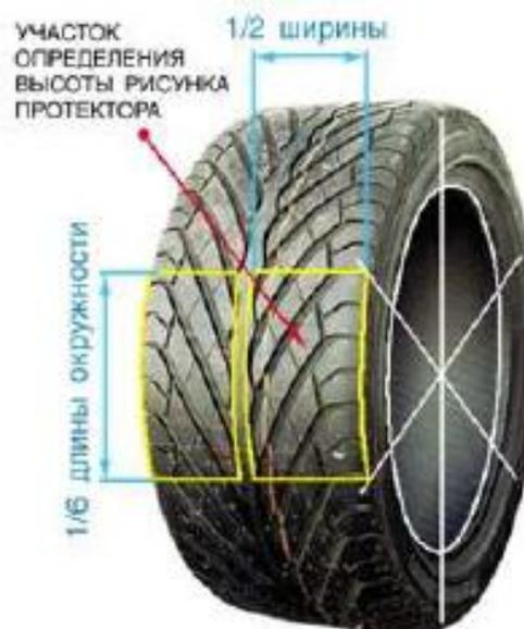
Рисунок 8.18 – Определение участка для диагностирования износа протектора
