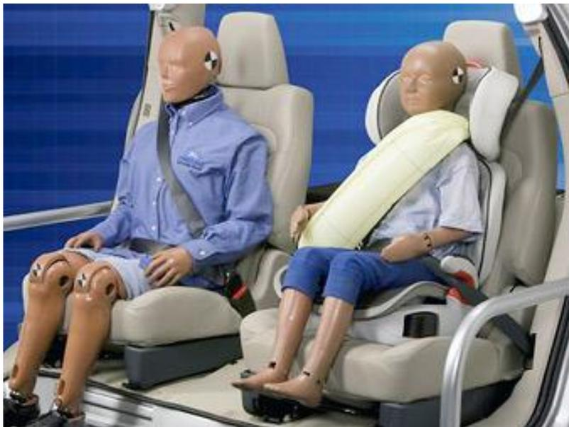
Задними ремнями со встроенными в них подушками безопасности уже оснащается американский вариант внедорожника Ford Explorer. При этом, по словам представителей производителя, они стали весьма популярной опцией — их на свои автомобили заказывали 40 процентов покупателей этой модели. Подобные ремни позволяют равномерно распределить нагрузку на грудную клетку пассажиров, что снижает вероятность получения серьезных травм. Подушки ремней надуваются специальным охлажденным газом за 40 миллисекунд.
