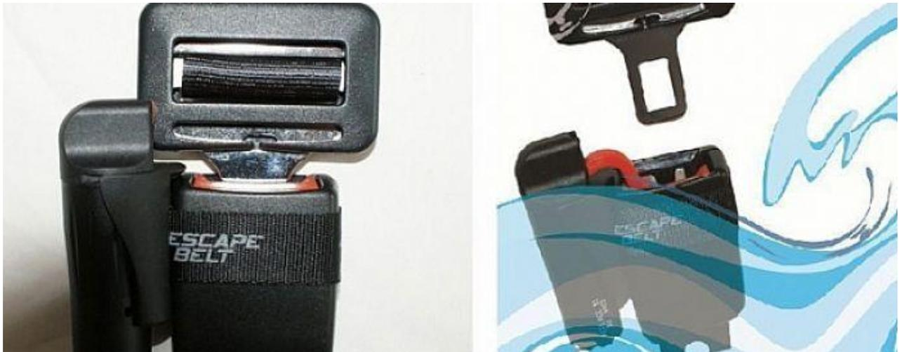
Новый ремень внешне ничем не отличается от обычных и не содержит сложных электронных устройств, благодаря чему его цена не превышает 40 долл. Внутри защелки нового ремня находится специальный картридж с таблеткой соли, которая очень быстро теряет прочность при намокании. Таким образом после погружения ремня в воду защелка автоматически срабатывает, и ремень за одну секунду выскакивает из замка. Водителю и пассажирам остается лишь открыть дверь, чтобы выбраться из тонущего автомобиля.
