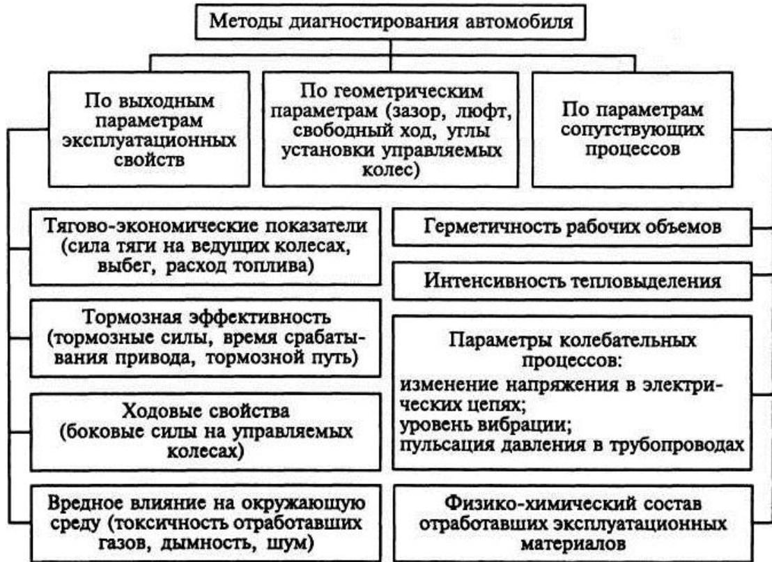
Рисунок 8.3 – Классификация методов диагностирования автомобилей
