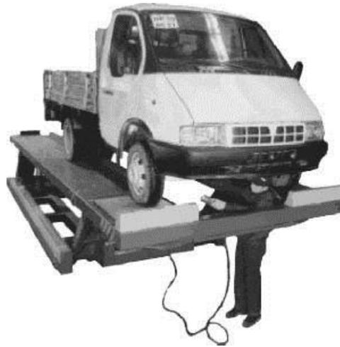
Люфт-детектор ДГ 015, установленный на автомобильном подъемнике
