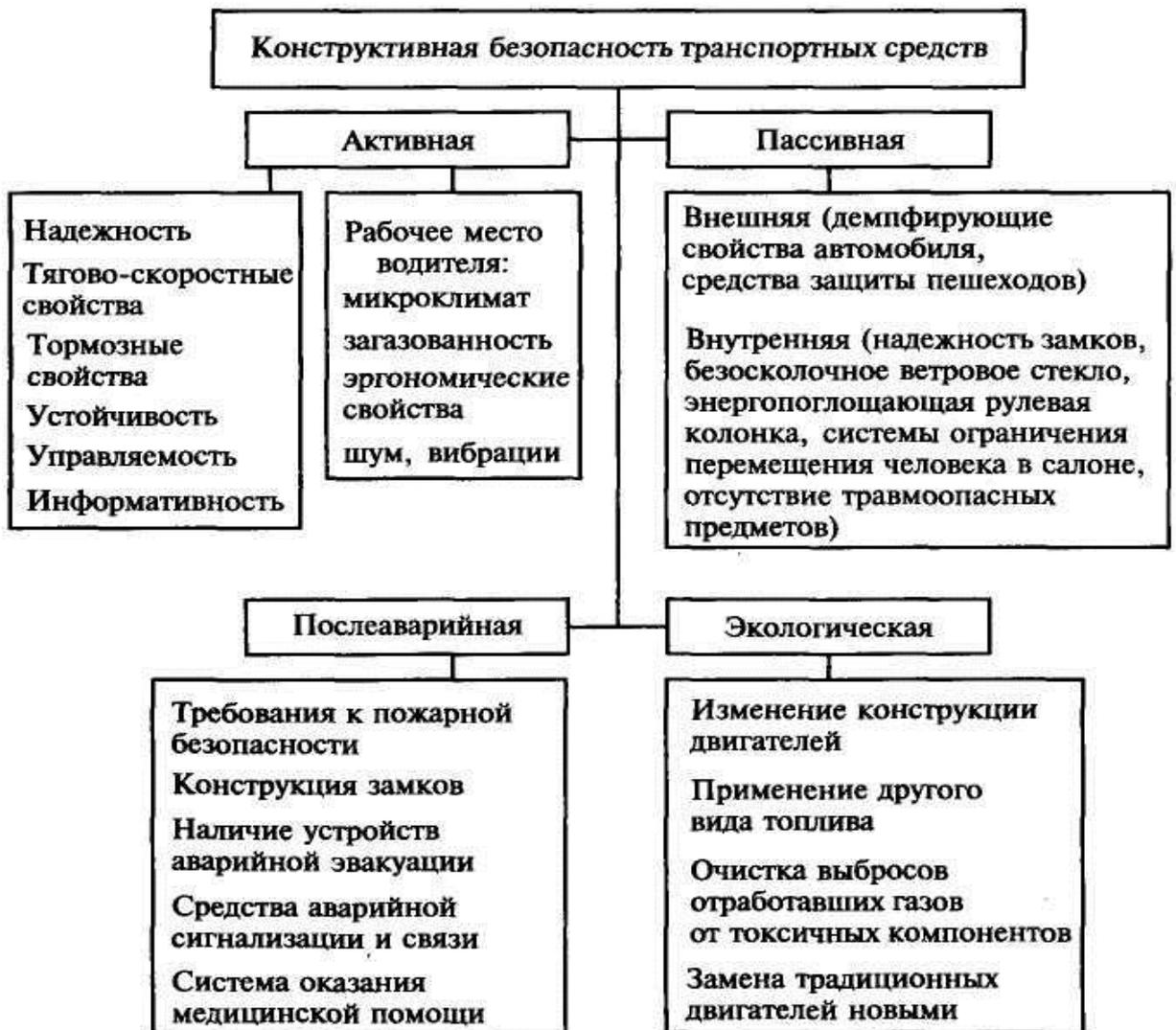
Рисунок 9.1. Структура безопасности автомобиля
