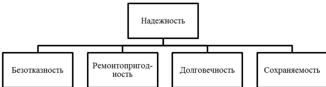
Рисунок 2.2 - Классификация свойств надежности машин и их элементов
