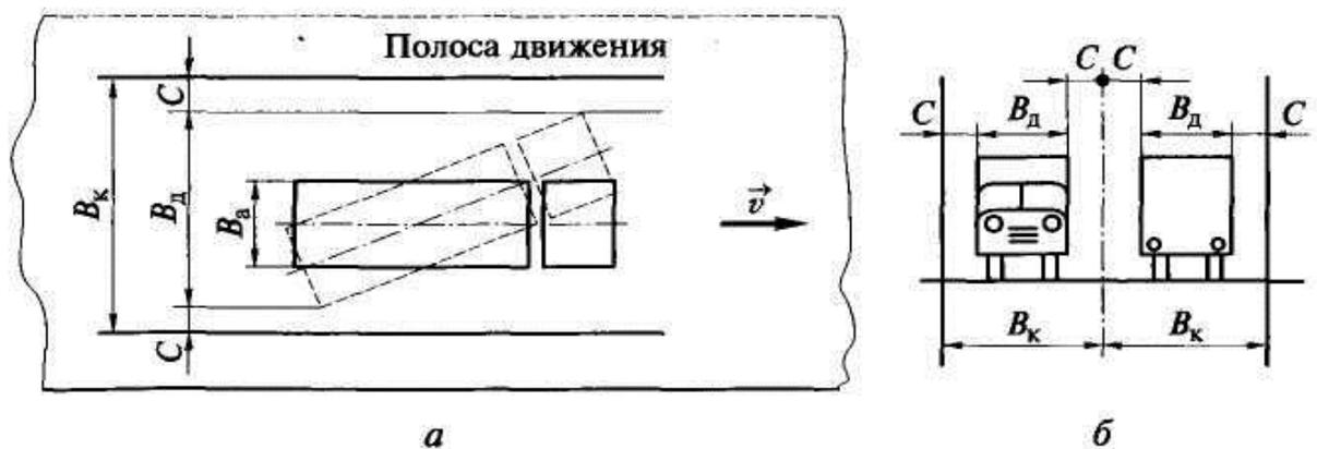
Рисунок 9.3. Коридор движения на однополосной (а) и двухполосной (б) дороге:  $B_a$  - статическая ширина автомобиля;  $B_d$  - динамическая ширина автомобиля;  $B_k$  - коридор движения;  $C$  - зазоры безопасности.
