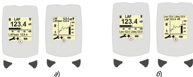
Рис. 5.8. Представление данных в виде гистограммы (А) и временной диаграммы (Б): а – Testo 816-1/-2; б – Testo 816-3/-4
