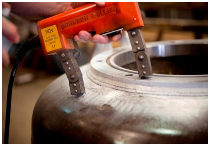
Рисунок 4.10. Процедура проведения магнитопорошковой дефектоскопии.
