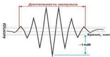
Рис. 2.10. Схема определения длительности импульса на уровне 14 дБ.
