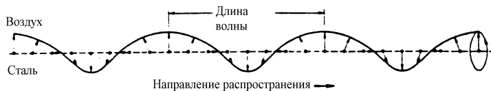
Рисунок 2.2. Распространение поверхностных волн.
