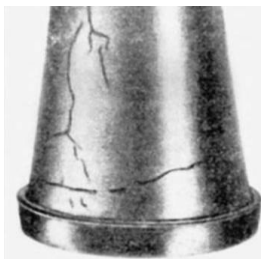
Рис. 4.3. Осадок магнитного порошка (из суспензии) на невидимых глазом закалочных трещинах стальной детали.
