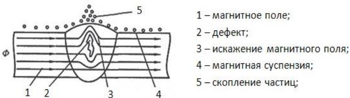
Рис. 4.2. Магнитопорошковый контроль сварного соединения.
