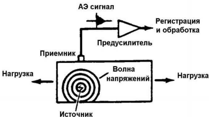
Рис.3.1. Принцип акустической эмиссии.
