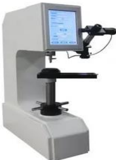
Рисунок 5.4. Универсальный твердомер HBRV-187.5ST с сенсорным экраном по Бринеллю, Роквеллу и Виккерсу.
