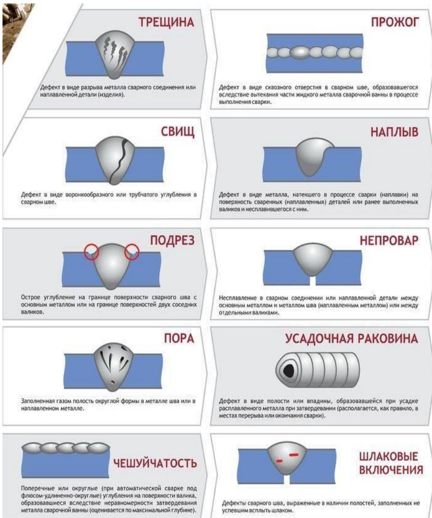
Рисунок 1.2. Дефекты сварных соединений, выявляемые при визуальном и измерительном контроле.
