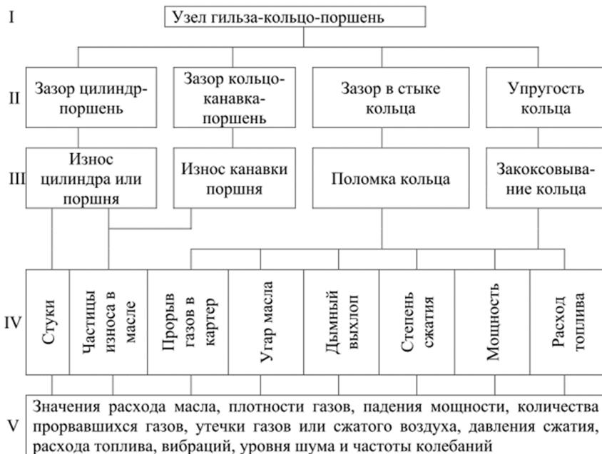
где I – объект; II – структурные параметры; III – неисправности; IV – диагностические параметры; V – значения диагностических параметров.
