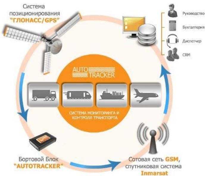
Рис. 9. Система мониторинга транспорта показатели, диспетчерского пункта, оснащенного компьютерной техникой и системами GSM связи, а также спутниковой навигационной системы GPS или ГЛОНАСС. Обе системы, американская и российская, первоначально предназначались для военных целей. С их помощью определялись координаты движущихся объектов. В последнее время обе системы используются и в коммерческих целях, для мониторинга транспорта и удаленного управления автомобилем.
