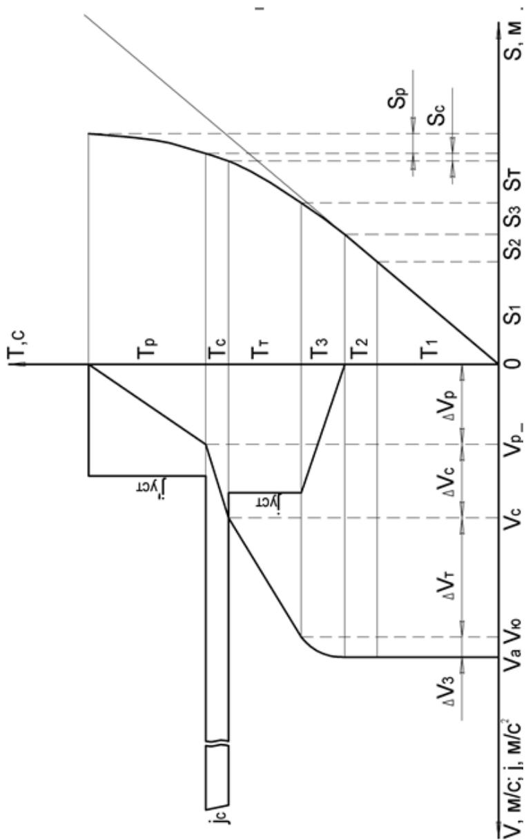
Рис. 3.1. Определение скорости ТС в момент их расхождения
