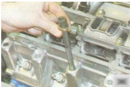
Рис. 1.11. Болты крепления головки блока цилиндров
