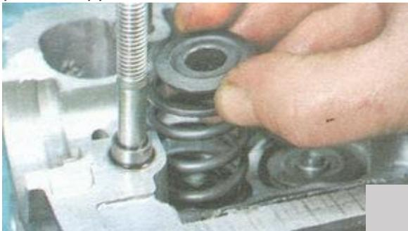
Рис. 1.27. Верхняя тарелка пружины клапана
