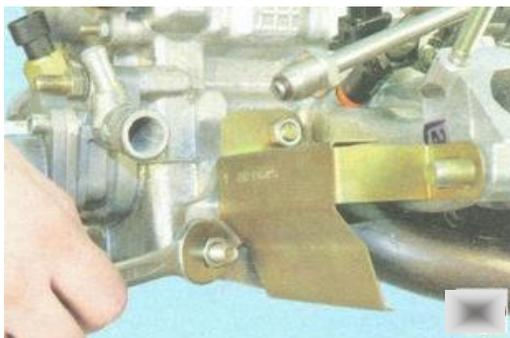
Рис. 1.3. Две гайки заднего крепления
