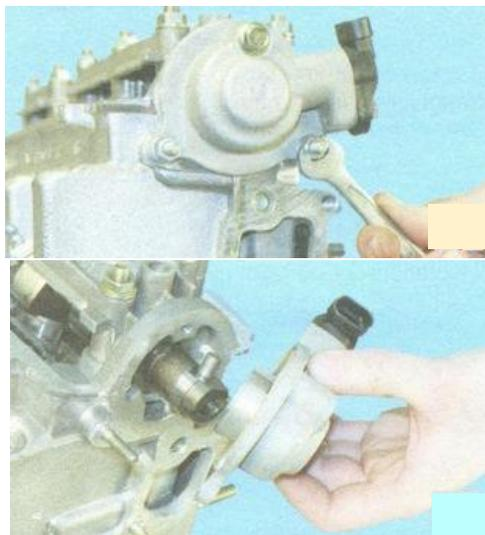
Рис. 1.9. Задняя крышка головки блока цилиндров
