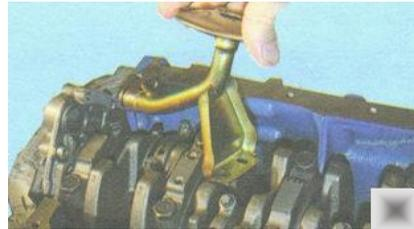
Рис. 1.14. Маслоприемник
