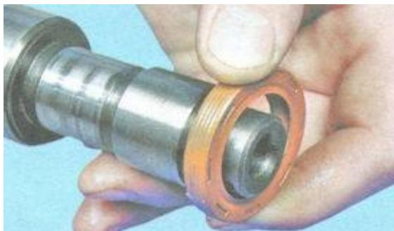
Рис. 1.22. Сальник с распределительного вала
