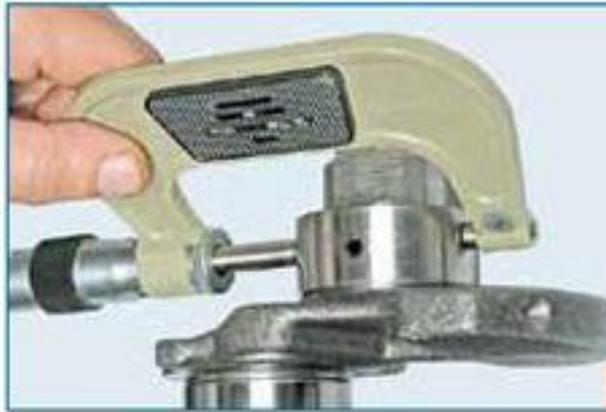
Рис. 1.20. Измерение микрометром диаметров шеек коленчатого вала
