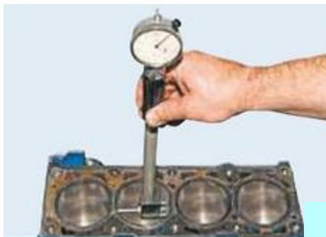
Рис. 1.19. Измерение нутромером диаметра цилиндра
