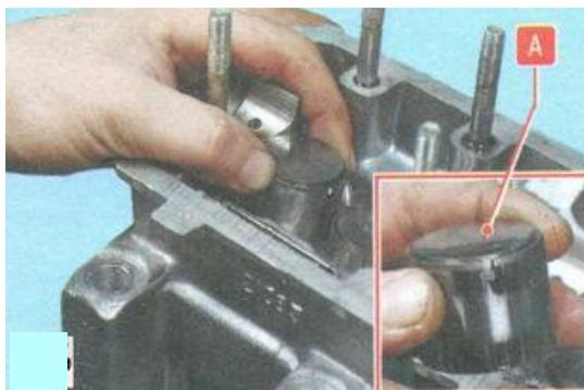
Рис. 1.23. Толкатели клапанов
