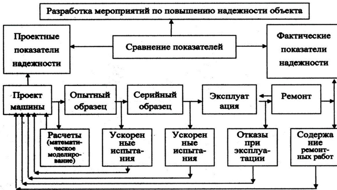
Рис. 1. Схема получения информации о надежности объекта
