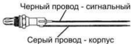
Рис. 7.2. Двухпроводной кислородный датчик
