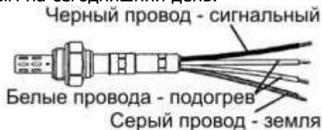
Рис. 7.4. Четырехпроводной кислородный датчик.
