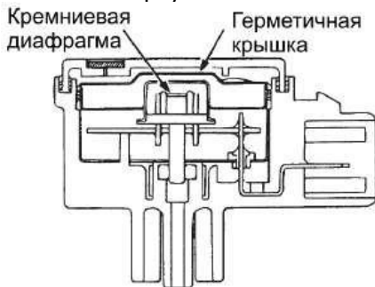
Рис. 6.5. Конструкция датчика абсолютного давления (MAP).
