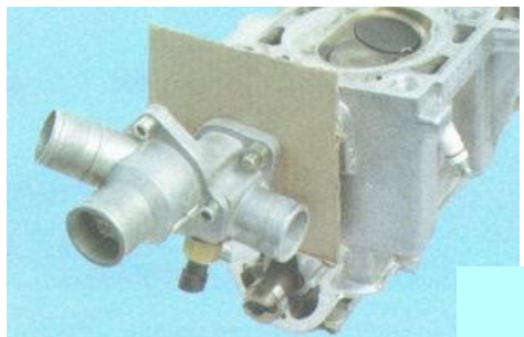
Рис. 1.28. Заглушите отверстие в головке блока цилиндров под гнездо термостата
