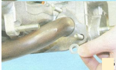
Рис. 1.5. Две гайки переднего крепления впускного коллектора (а) и катколлектора (б)
