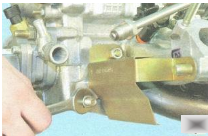
Рис. 1.3. Две гайки заднего крепления впускного коллектора и катколлектора
