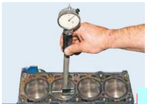
Рис. 1.19. Измерение нутромером диаметра цилиндра
