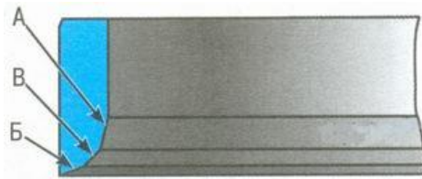
Рис. 1.36. Места притирки (обработки) фасок седел клапанов
