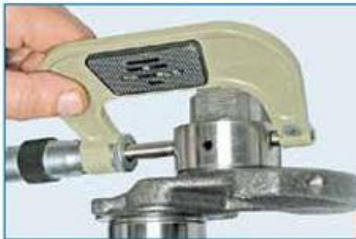
Рис. 1.20. Измерение микрометром диаметров шеек коленчатого вала
