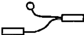
Рис. 7.6. Переходник АСЕ10.002.208 для подключения к катушкам зажигания типа 3012.3705
