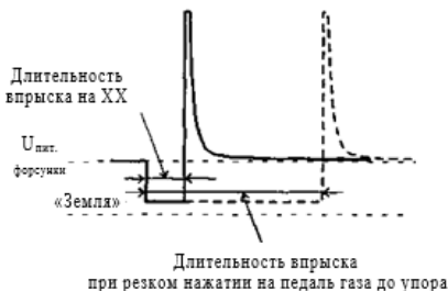
Рис. 7.18. Сигнал импульса впрыска
