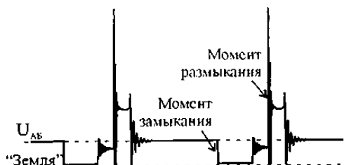
Рис. 7.11. Расположение моментов размыкания и замыкания контактов прерывателя
