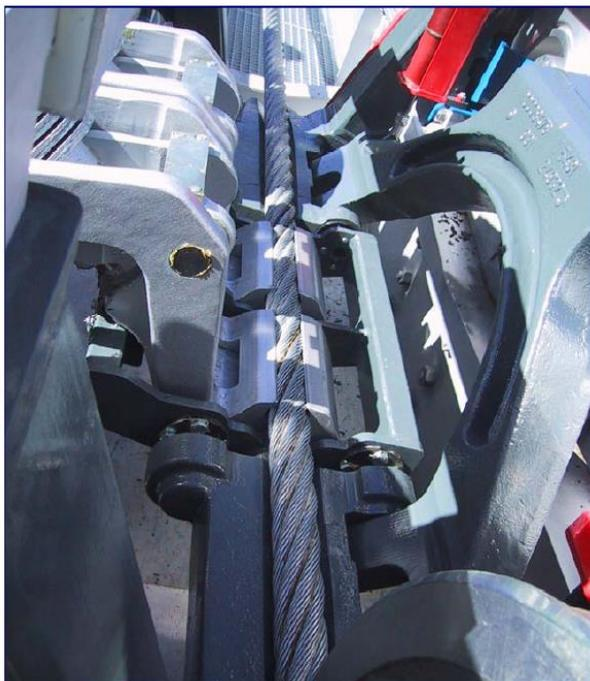
Рис. 31. Общий вид зажима подвески кабины, расположенной на каретке
