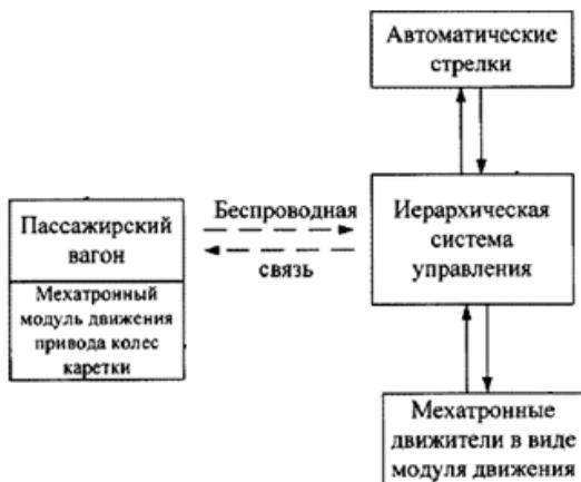
Рис. 52. Схема функциональной связи иерархической системы управления
