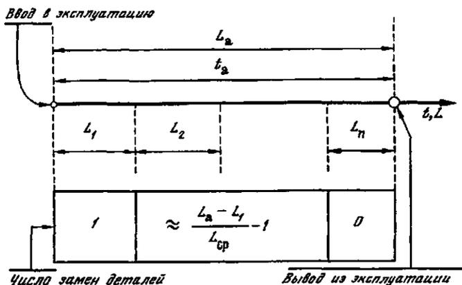
Рисунок 1.2 – Схема замены деталей
