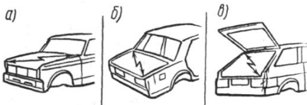
Рис.13. Перекос кузова малой сложности: а - проёма капота; б - проёма крышки багажника; в - двери задка
