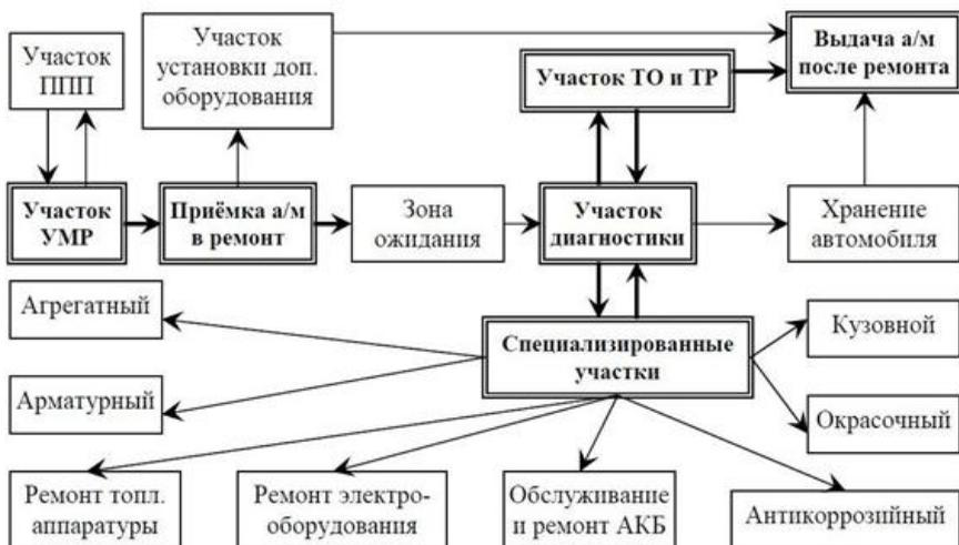
Рис. 4. Технологический маршрут ТО и ремонт автомобилей на СТОА:
