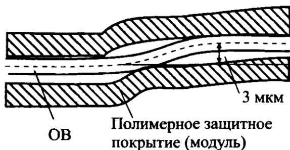
Рисунок 8.4 – Формирование микроизгиба оптического волокна
