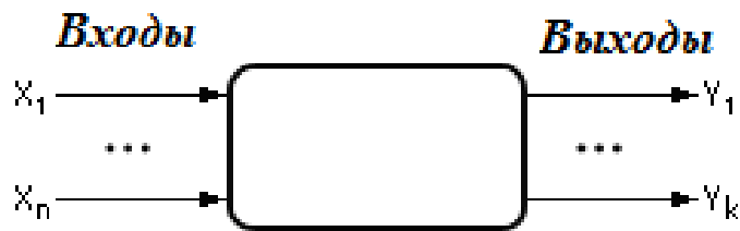
Рисунок 5.1 – Обозначение черного ящика на схемах
