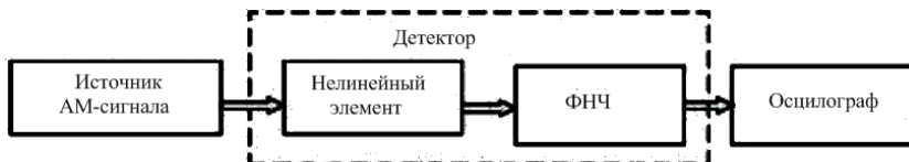
Рисунок 4.1 – Структурная схема исследования амплитудного детектора
