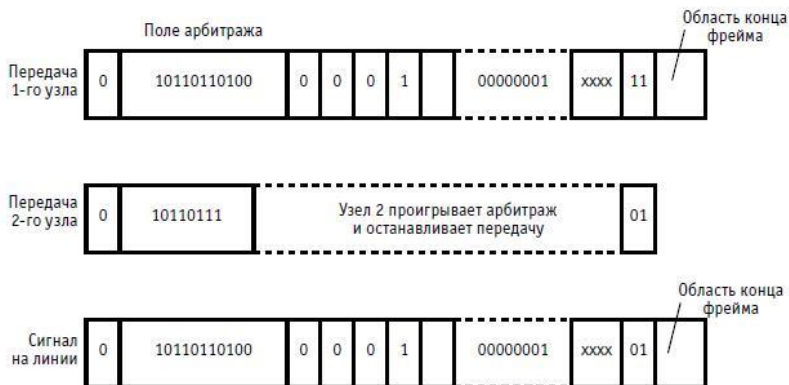
Рис. 1.8. Пример поразрядного арбитража
