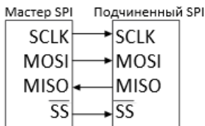
Рис. 2.1. Простейшее подключение к шине SPI
