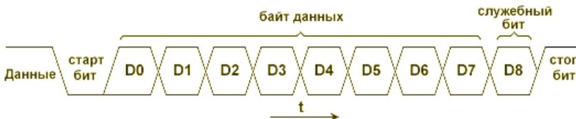
Рисунок 3.14 – Асинхронный последовательный формат передачи данных
