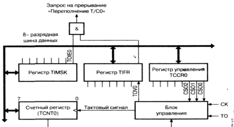
Рисунок 3.5 – Структурная схема таймера/счетчика *T0*
