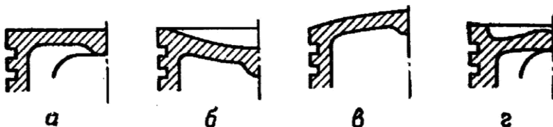
Рисунок Ошибка! Текст указанного стиля в документе отсутствует..14 Формы днищ поршней а – плоская; б – вогнутая; в – выпуклая; г – фасонная
