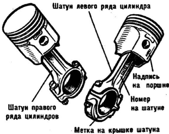
Рисунок Ошибка! Текст указанного стиля в документе отсутствует.. 22 Установка двух шатунов на одной шейке V – образного двигателя.
