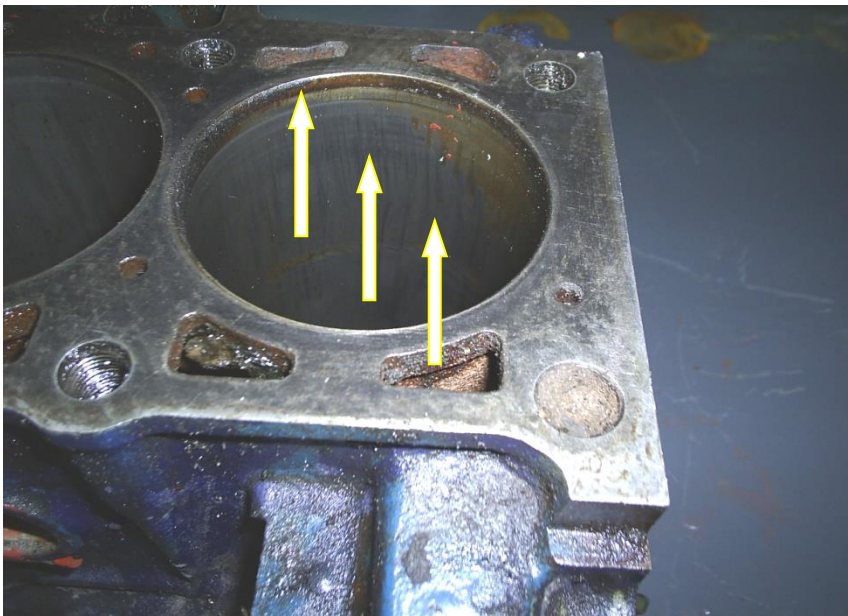
Рисунок 3. Места измерения геометрических размеров гильзы цилиндра
