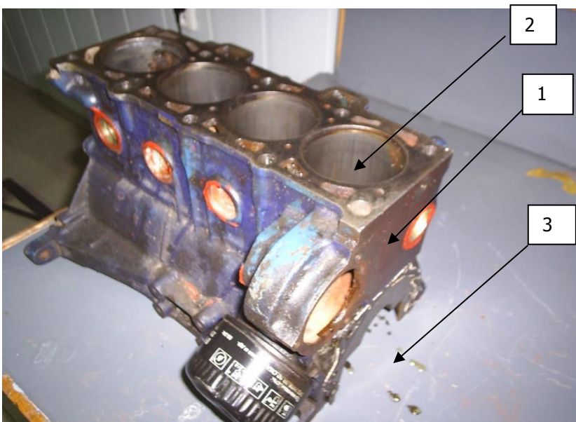
Рисунок 1 Блок цилиндров с гильзами на лабораторном столе 1 – блок цилиндров, 2 – гильза, 3 – лабораторный стол
