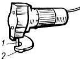
Рисунок 10 – Переносные электромеханические ножницы
