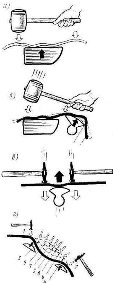
Рисунок 2 – Восстановление формы деталей с использованием рихтовочного инструмента
