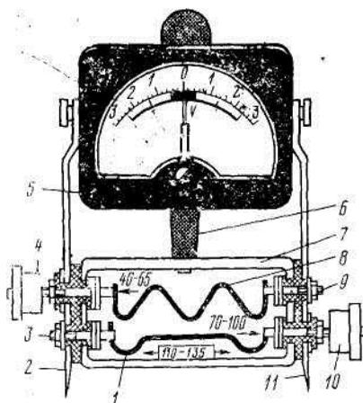
Рисунок 5 – Схема нагрузочной вилки ЛЭ-2.
