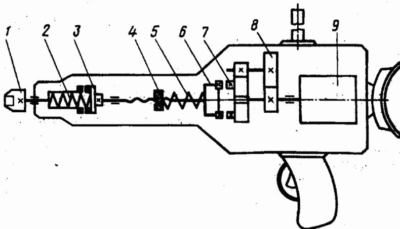
Рисунок 2 – Схема электрического гайковерта
