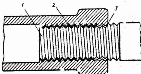
Рисунок 7 – Механизм полимеризации анаэробного материала в резьбовом стыке: 1 – резьбовой элемент; 2 – анаэробный материал; 3 – зазор
