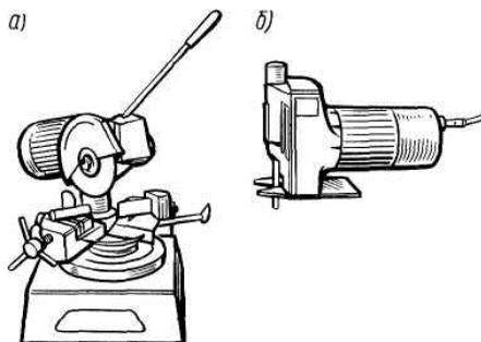
Рисунок 8 – Устройства для механического распиливания: а — отрезной станок; б — переносная электрическая ножовка.
