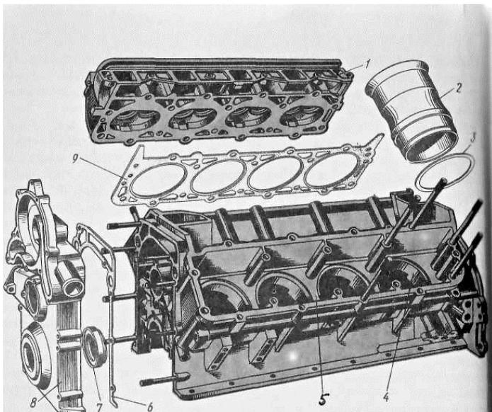
Рисунок 2 – Головка и блок цилиндров V-образного восьмицилиндрового двигателя ЗМЗ-53: 1 – головка правого ряда цилиндров, 2 – гильза цилиндра, 3 – прокладка гильзы, 4 – направляющий поясok для гильзы, 5 – блок цилиндров, 6 – прокладка крышки распределительных шестерен, 7 – сальник переднего конца коленчатого вала, 8 – крышка распределительных шестерен, 9 – прокладка головки цилиндров
