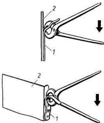
Рисунок 12 – Удаление полосы с точечной сваркой ручным инструментом: 1 – полоса металла; 2 – деталь кузова
