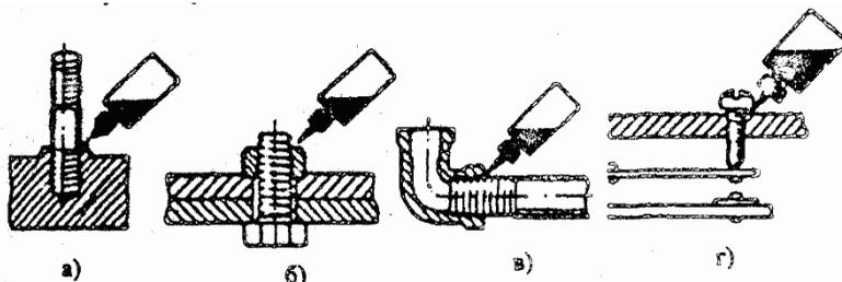
Рисунок 6 – Стопорение (стабилизация) резьбовых соединений деталей анаэробным полимерным материалом: а – соединение «шпилька-корпус»; б – болтовое соединение; в – соединение трубопроводов; г – соединение «винт корпус».
