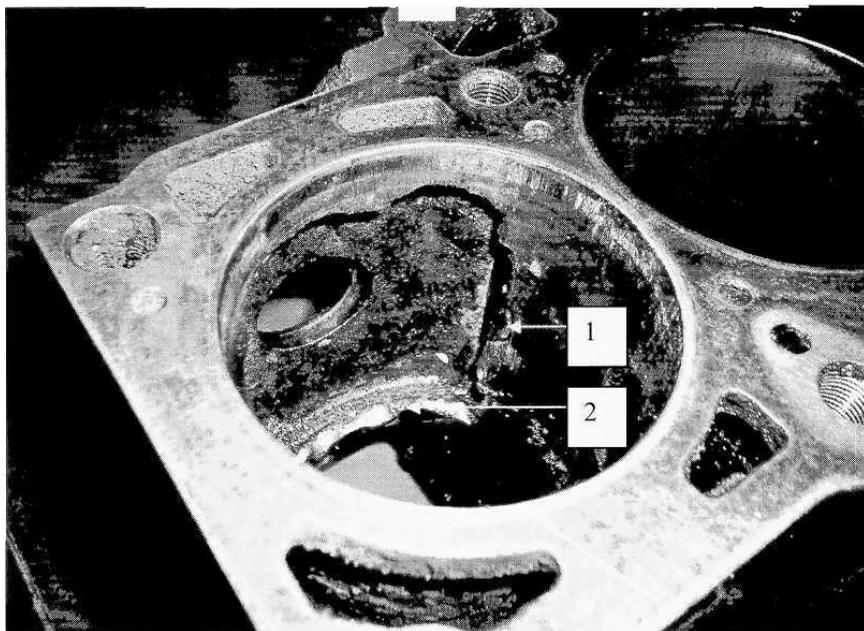
Рисунок 3 – Дефекты гильзы цилиндра: 1 – трещина, 2 – облом гильзы
