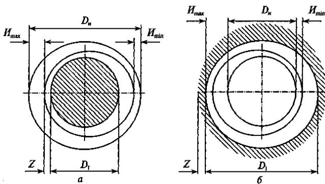
Рисунок 1 – Схема к расчету ремонтных размеров: *a* — для вала; *б* — для отверстия
