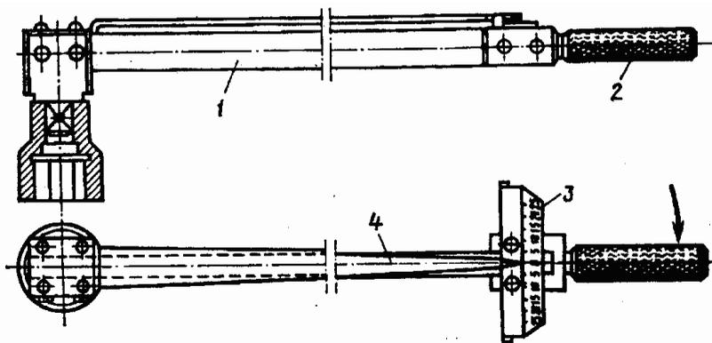
Рисунок 1 – Динамометрический ключ
