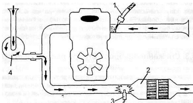
Рисунок 12 – Система с пламенным подогревом нейтрализатора:
