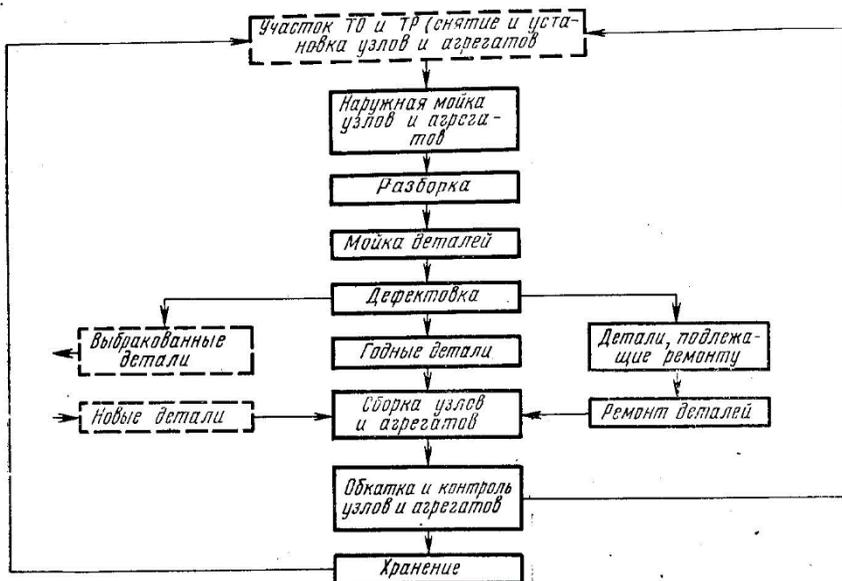
Рисунок 4 – Схема технологического процесса текущего ремонта узлов и агрегатов
