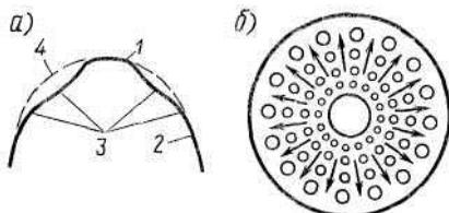
Рисунок 1 – Устранение выпучин в панелях кузова без нагрева:
