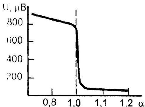
Рисунок 11 – Характеристика циркониевого  $\lambda$ -зонда при температуре 600°C
