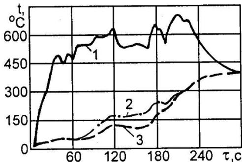
Рисунок 14 – Изменение температуры в нейтрализаторах при прогреве двигателя: 1 – стартовый нейтрализатор; 2 – основной нейтрализатор (при работе стартового); 3 – основной нейтрализатор (без стартового)
