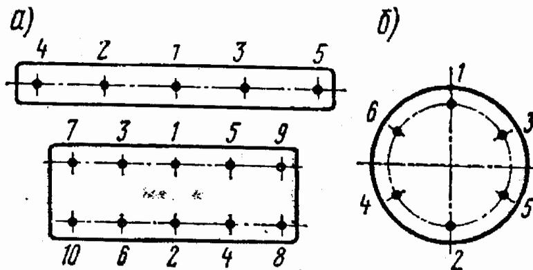
Рисунок 5 – Последовательность затяжки гаек на различных поверхностях
