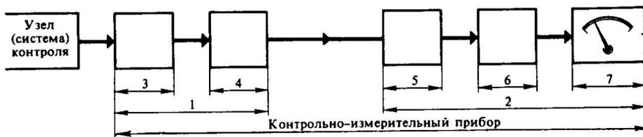
Рисунок 6 – Структурная схема контрольно – измерительного прибора (указателя): 1 – датчик, 2 – приемник, 3 – чувствительный элемент датчика, 4 – преобразователь сигнала в датчике, 5 – чувствительный элемент приёмника, 6 – преобразователь сигнала в приёмнике, 7 – шкала показаний приёмника.
