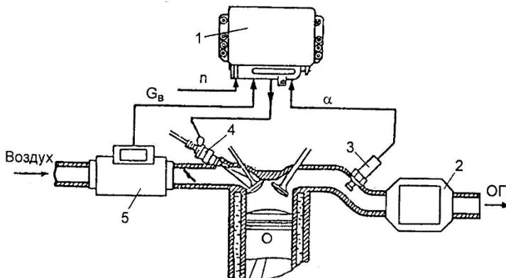
Рисунок 9 – Управление топливоподачей по сигналу  $\lambda$  -зонда:
