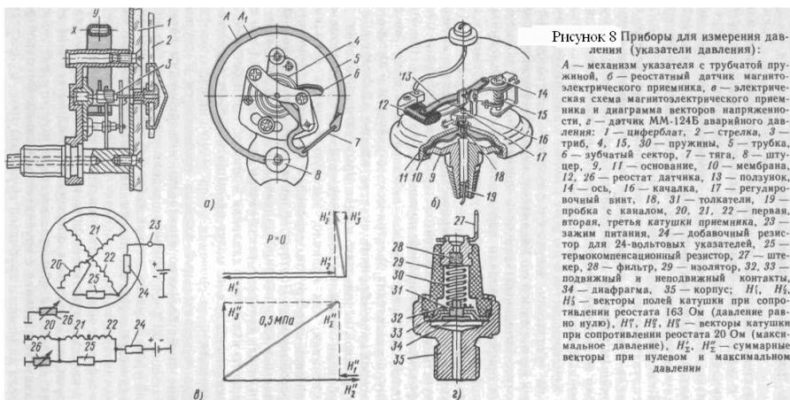
Рисунок 8 Приборы для измерения давления (указатели давления):
