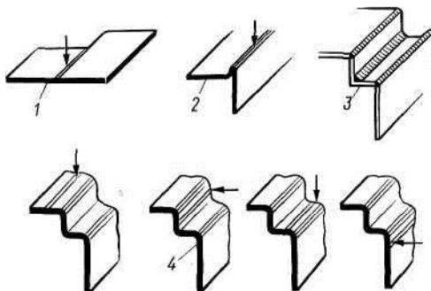
Рисунок 13 – Виды сварных соединений: 1 — встык; 2 — с отбортовкой кромки; 3 — внутренний или наружные угловые швы; 4 — расположение сварочного шва, позволяющего производить рихтовку (показано стрелкой)
