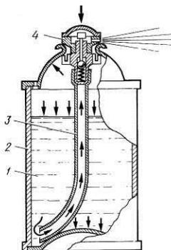
Рисунок 5 – Схема устройства аэрозольного баллона: 1 — смесь лакокрасочного материала с пропеллентом; 2 — баллон; 3 — сифонная трубка; 4 — распыляющее устройство с клапаном
