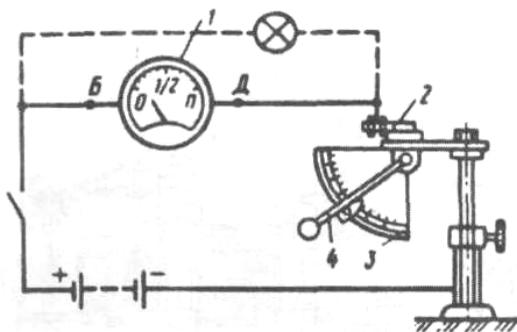
Рисунок 2 – Проверка датчика магнитоэлектрического указателя уровня топлива
