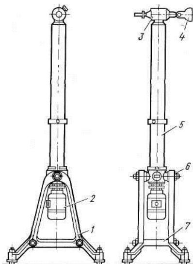
Рисунок 2 – Электромеханический краскораспылитель: 1 – стойка станины; 2 – электромеханический привод; 3 – головка; 4 – насадка; 5 – стойка; 6 – зажимное устройство; 7 – стяжка станины
