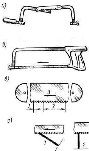
Рисунок 7 – Устройства для ручного распиливания: а — корпус ножовки; б — ножовка в сборе с полотном; в — элементы ножовочного полотна; (1 шаг зубьев; 2 — число зубьев на 1 см полотна; 3 — направление зубьев); г — приемы распиливания (1 — правильно; 2 — **неправильно**)
