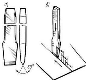
Рисунок 5 – Рубка ручным зубилом: а) ручное зубило; б) непрерывная рубка посредством наложения резов друг на друга
