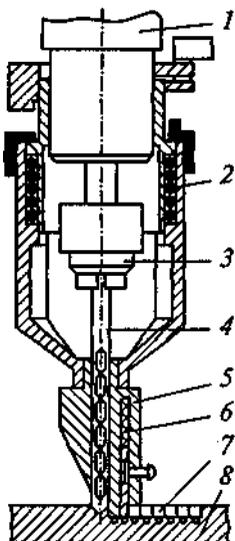
Рисунок 5 – Кондуктор для сверления отверстий под фигурные вставки: 1 — шпиндель сверлильной машины; 2 — приспособление для сверления; 3 — патрон; 4 — сверло; 5— кондуктор; 6— фиксаторы; 7— просверленные отверстия; 8 — деталь
