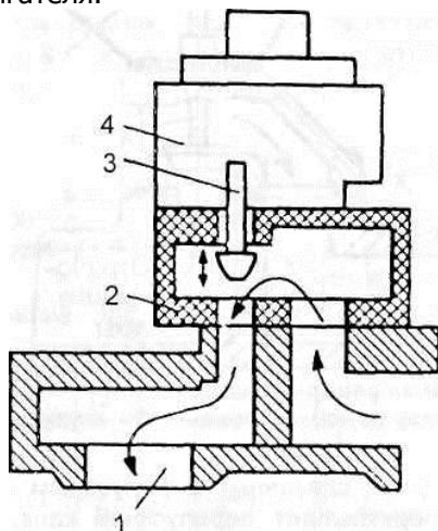
Рисунок 7 – Клапан рециркуляции с шаговым двигателем:
