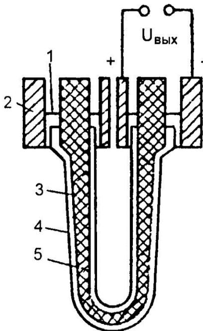
Рисунок 10 – Схема циркониевого  $\lambda$ -зонда:
