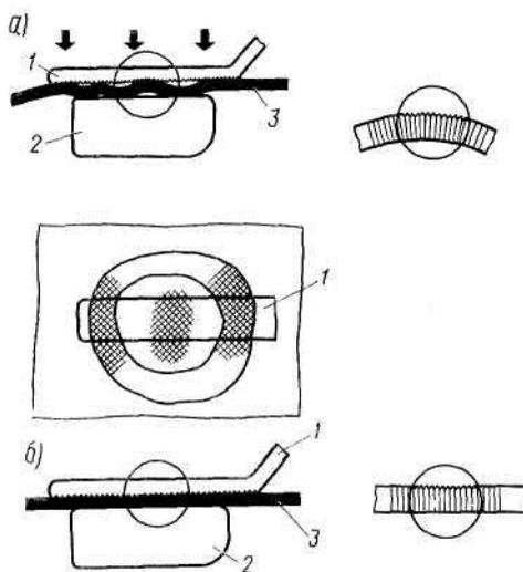
Рисунок 3 – Рихтовка небольших деформированных участков панелей:
