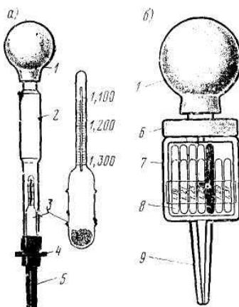
Рисунок 4 – Приборы для измерения плотности электролита
