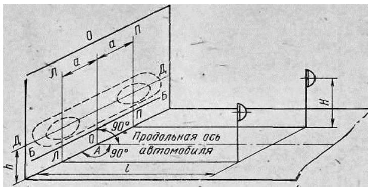
Рисунок 12 – Экран для проверки установки фар:
