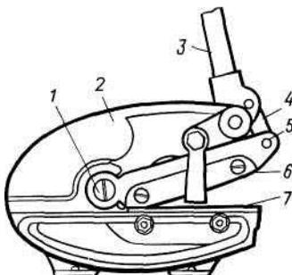
Рисунок 9 – Стационарные ножницы с ручным приводом
