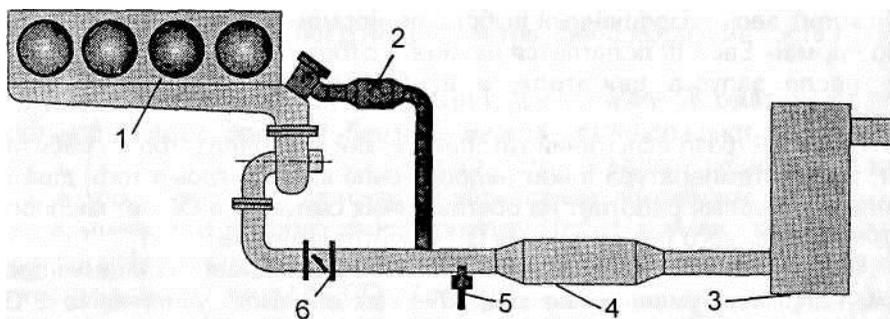
Рисунок 13 – Система со стартовым нейтрализатором:
