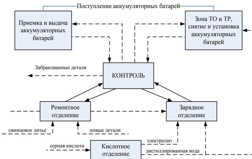
Рисунок 2 – Схема технологического процесса ремонта и заряда аккумуляторных батарей.
