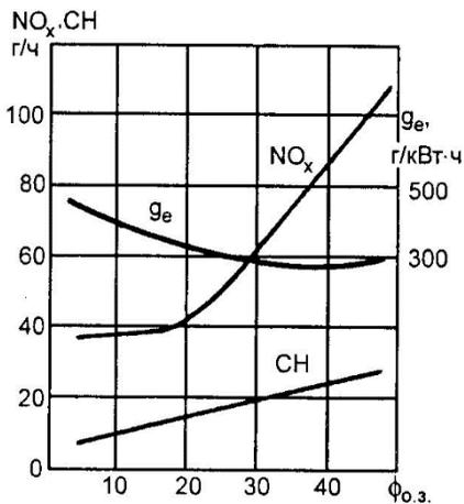
Рисунок 4 – Влияние угла опережения зажигания ( $\phi_{0.3}$ ) на выброс  $\text{NO}_x$  и  $\text{CH}$  с ОГ
