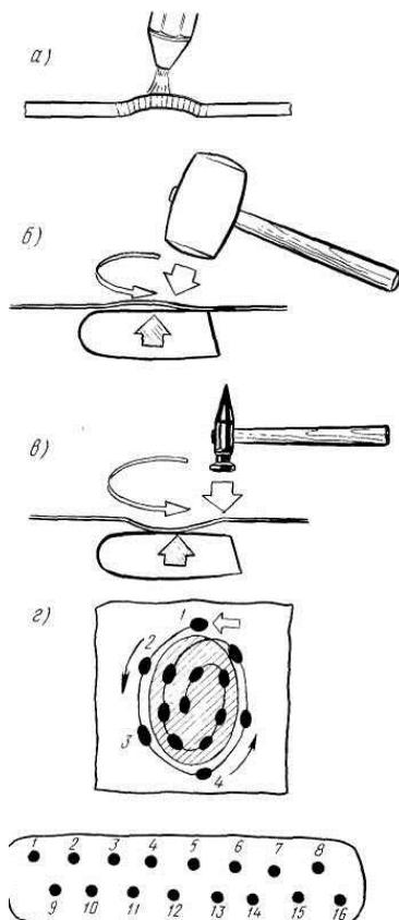
Рисунок 4 – Устранение обширных выпуклостей (вмятин) на поверхности кузова методом нагрева в сочетании с ударным воздействием: *а* — нагрев металла; *б* — осаждение выпуклости киянкой на плите; *в* — устранение вмятины молотком на фасонной плите; *г* — последовательность нагрева и осаждения металла при устранении выпуклостей (вмятин)
