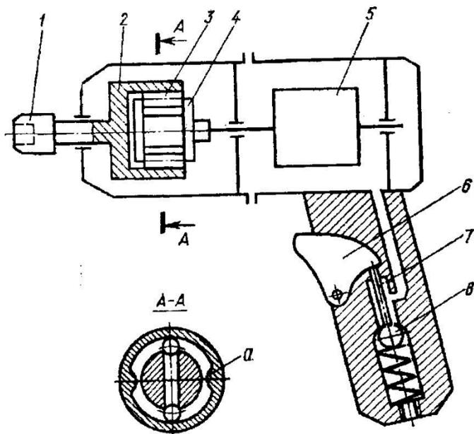
Рисунок 3 – Ударно-импульсный инструмент
