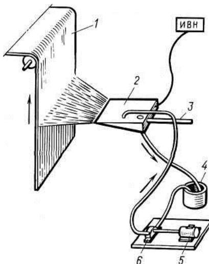
Рисунок 3 – Электростатический распылитель: 1 – изделие; 2 – лоток; 3 – изоляционная штанга; 4 – емкость для ЛКМ; 5 – электропривод; 6 – насос
