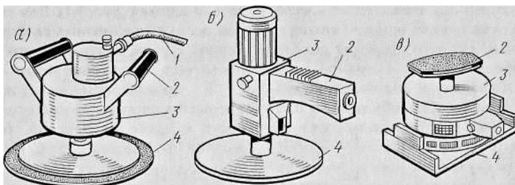
Рисунок 1 – Ручные пневматические машины для сухого шлифования и полирования: а — МШ-1М; б — МШ-2М; в — МШ-3; 1 — шланг для подачи сжатого воздуха; 2 — рукоятка; 3 — пневмодвигатель; 4 — рабочий диск
