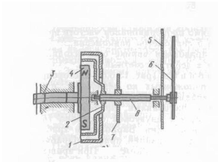
Рисунок 11 – Устройство магнитоиндукционного спидометра
