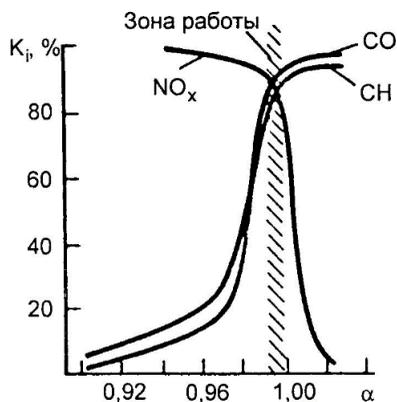
Рисунок 8 – Зона эффективной работы трехкомпонентного нейтрализатора
