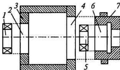
Рисунок 1 – Схема восстановления неподвижных сопряжений:
