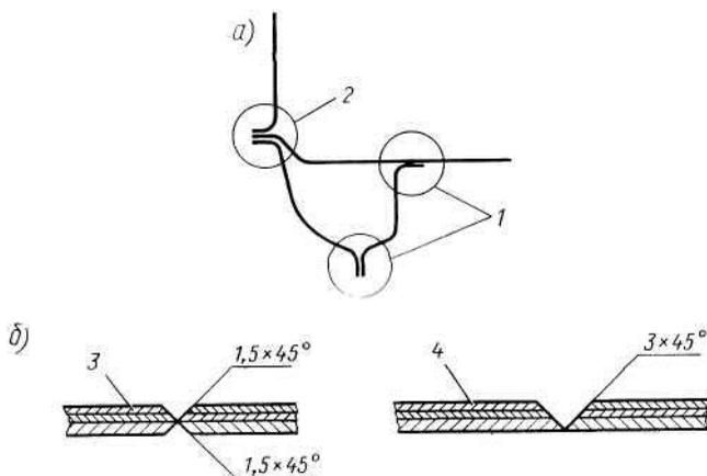
Рисунок 11 – Соединение панелей кузова: а – виды соединения панелей (1 – двух; 2 – трех); б – снятие фасок для сварки (3 – двусторонней, 4 – односторонней)
