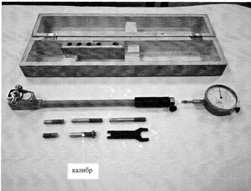
Рисунок 8 – Тарировка нутромера
