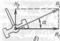
Рисунок 10 – Указатель тока (амперметр) с неподвижным магнитом: а – устройство, б – векторная диаграмма сил, действующих на якорь указателя; 1 – зажим, 2 – стрелка, 3 – магнитный шунт, 4 – постоянный магнит, 5 – основание, 6 – якорь, 7 – ось, 8 – опора
