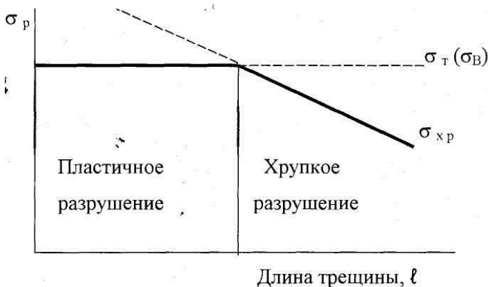
Рисунок 25 – Влияние размера трещины на характер разрушения
