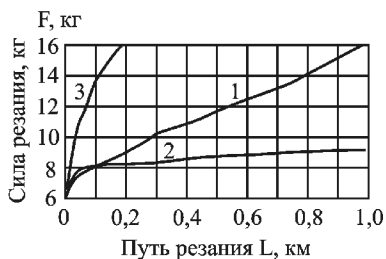
Рис.2.30. Кривые затупления при резании со скоростью 5 м/с свежей сосны (влажность 110%): 1– без электризации; 2 – инструмент подключен к отрицательному полюсу; 3 – инструмент подключен к положительному полюсу [314]
