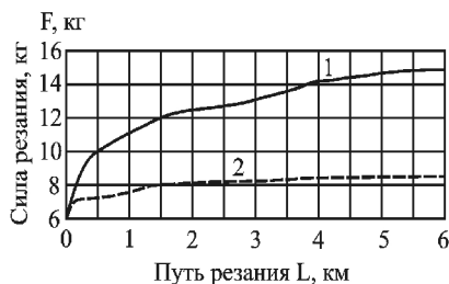
Рис.2.31. Кривые изменения силы резания при фрезеровании со скоростью 50 м/с свежей сосны (влажность 110 %) от пути резания: 1 – без электризации; 2 - фреза подключена к отрицательному полюсу [314]
