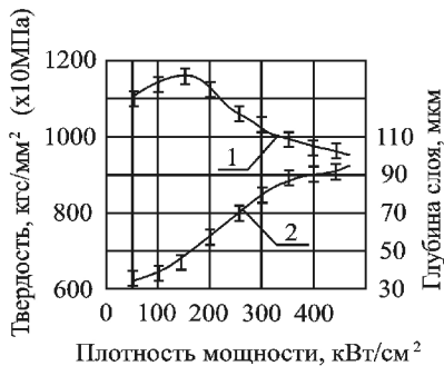
Рис.2.23. Влияние энергии излучения на твердость упрочненного слоя стали Р6М5: 1- \tau \sim 1 мс; 2- \tau \sim 4-6 мс [207]
