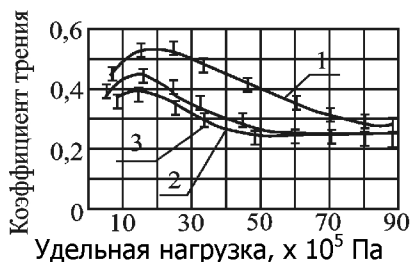
Рис.2.25. Влияние удельной нагрузки на коэффициент трения стали Р6М5 по стальному контртелу после стандартной термообработки (1), лазерной закалки (2), лазерного легирования (3) [207]
