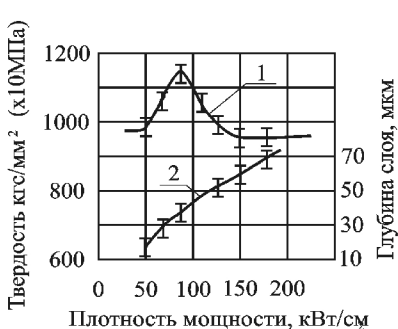
Рис.2.23. Влияние энергии излучения на твердость упрочненного слоя стали Р6М5: 1- \tau \sim 1 мс; 2- \tau \sim 4-6 мс [207]
