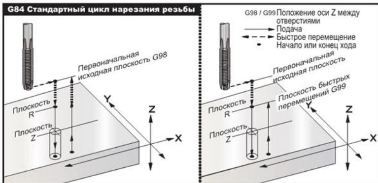
Рис. 11. Параметры стандартного цикла нарезания резьбы G84
