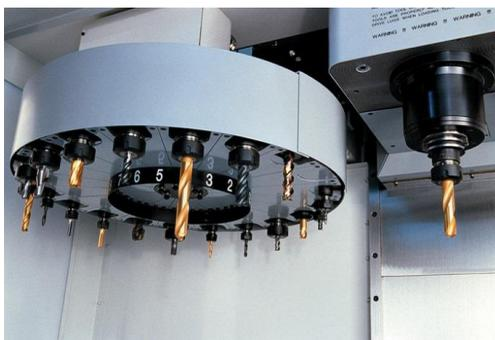
Рисунок 1.6 - Карусельное устройство смены инструмента на 20 гнезд
