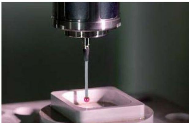
Рисунок 3.2 - 3D-щуп для измерения заготовки непосредственно на станке
