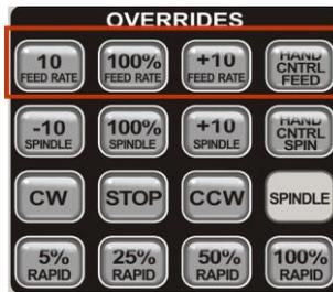
Рисунок 3.5 – Клавиши ручной коррекции программируемых подач
