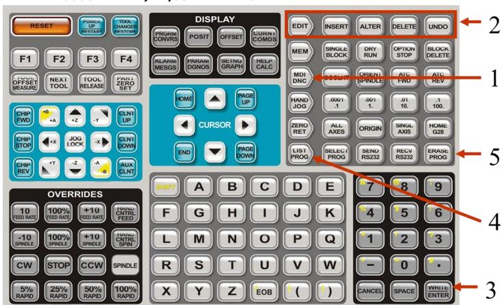
Рисунок 4.1 - Клавиатура подвесного пульта управления вертикально-фрезерного обрабатывающего центра с ЧПУ HAAS VF2-УТ
