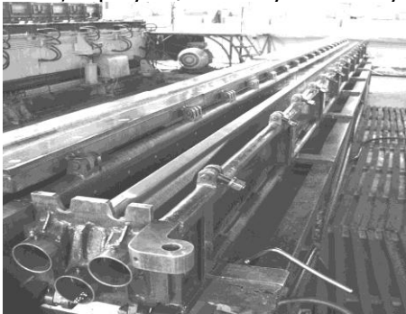
Рис.46. Станок для виброупрочнения лонжерона лопасти вертолета.
