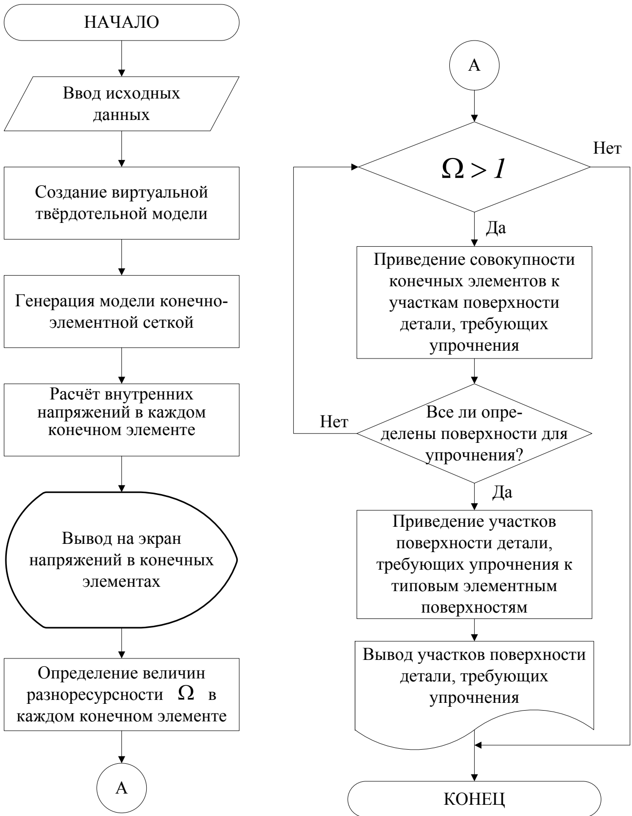
Рис.18. Алгоритм выбора поверхностей, подлежащих упрочняющей обработке ППД
