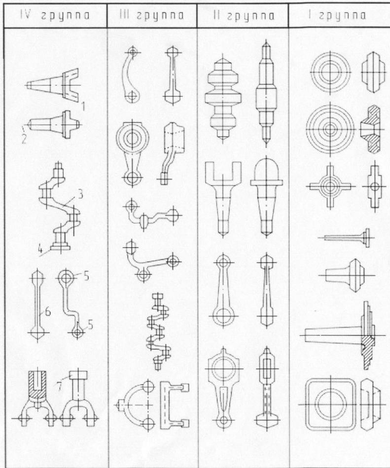
Рис.2. Классификация поковок, штампемых на молотах и кривошипных горячештамповочных прессах
