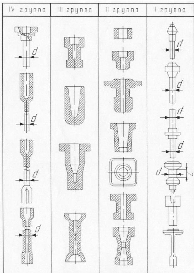
Рис. 1. Классификация поковок, штампуемых на горизонтально-ковочных машинах
