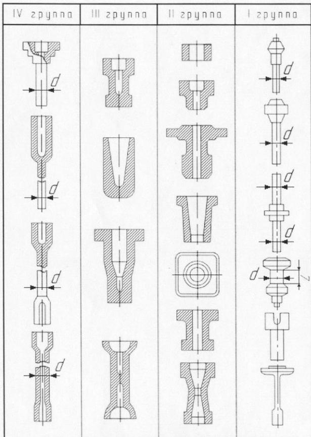
Рис. 1. Классификация поковок, штампемых на горизонтально-ковочных машинах
