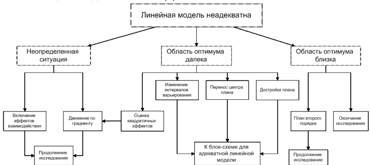
Рис 2 Блок-схема принятия решений в задаче оптимизации для случая, когда линейная модель неадекватна.
