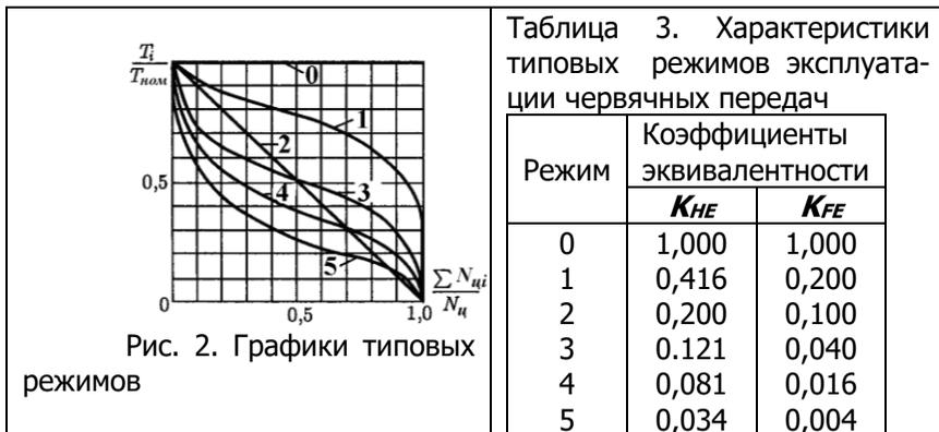
Таблица 3. Характеристики типовых режимов эксплуатации червячных передач
