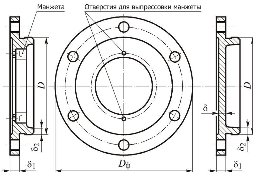
Рис. 38. Крышки подшипников: слева – сквозная, справа – глухая
