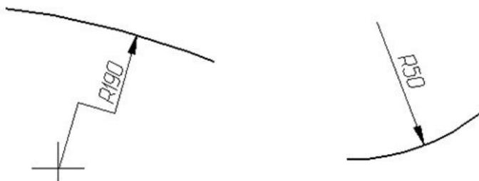
Рисунок 29 - Примеры нанесения размера радиуса
