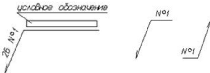
Рисунок 103 - Обозначение одинаковых сварных швов на чертеже
