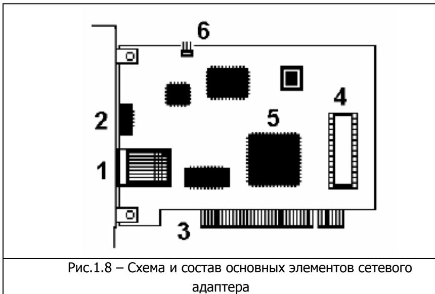
Рис.1.8 – Схема и состав основных элементов сетевого адаптера
