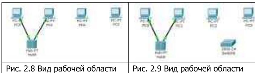
Далее размещаем на рабочей области симулятора коммутатор, например, модель 2950-24 (рис. 2.9). Описание семейства коммутаторов серии 2950 можно найти на сайте компании Cisco Systems. [Электронный ресурс]. URL:
