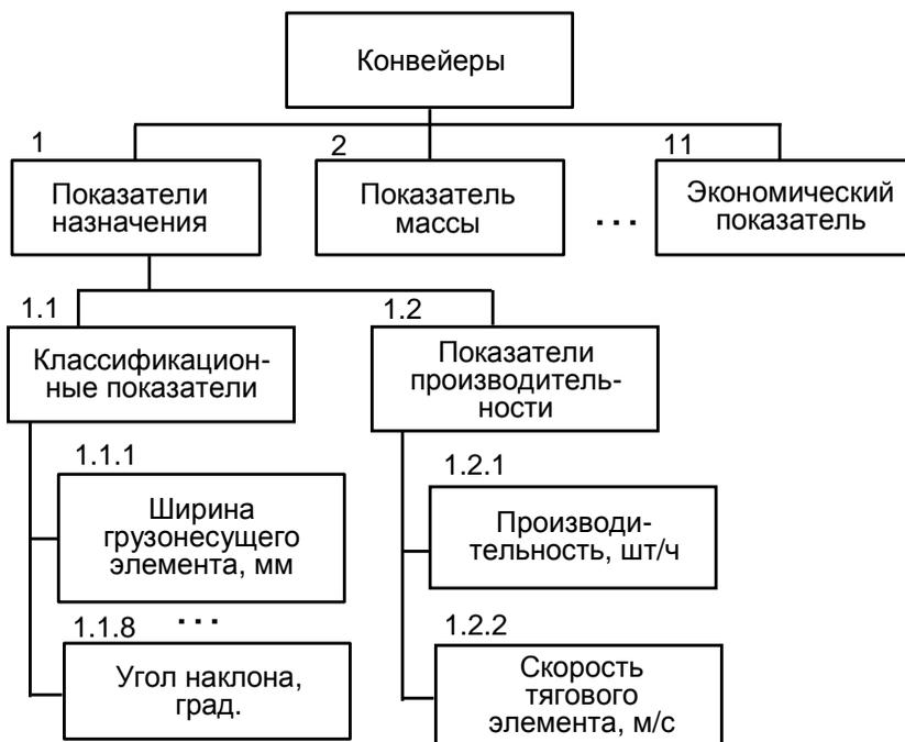
Рис. 2. Структурная схема номенклатуры показателей качества
