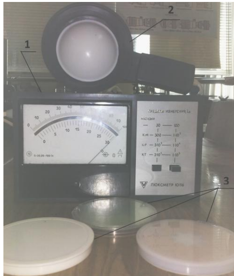
Рис.3 – Люксметр Ю 116: 1 – измеритель; 2 – фотоэлемент; 3 – насадки
