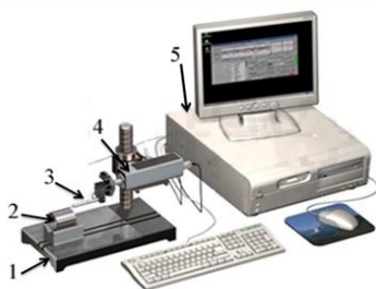
Рисунок 4 – Профилометр: 1 – приборная стойка; 2 – контролируемая деталь; 3 – консоль с иглой; 4 – индуктивный преобразователь; 5 – персональный компьютер
