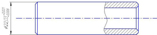
Рисунок 1 – Палец поршневой с указанием предельных размеров
