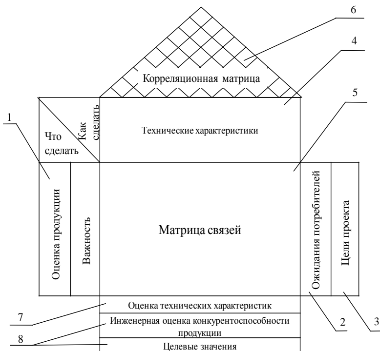
Рисунок 2 – Базовая структура QFD-диаграммы («Дома Качества»)
